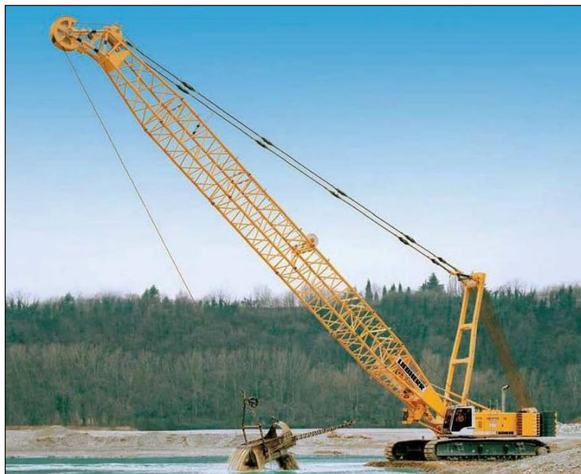
Slika 10. Bager s povlačnim košem (dragline)
